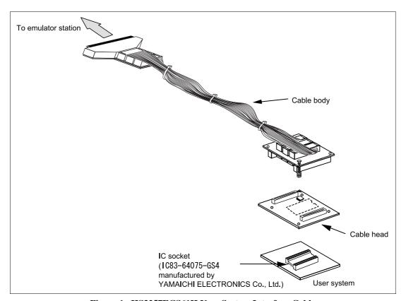
Figure 1 HS3257ECS61H User System Interface Cable
